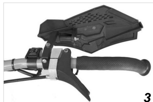
**ÉTAPE 3 :** Insérez le boulon M6 de 25 mm avec la rondelle plate dans le support et le collier. Vissez-le dans l'écrou carré et serrez. Ce boulon d'ajustement est utilisé pour obtenir le serrage désiré du support. Pour le moment, laissez le support lâche pour pouvoir régler la position vers le haut ou vers le bas après avoir attaché le protège-main au support.
